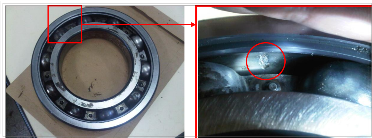
Figura 19 – Detalhe da falha na pista interna do rolamento
